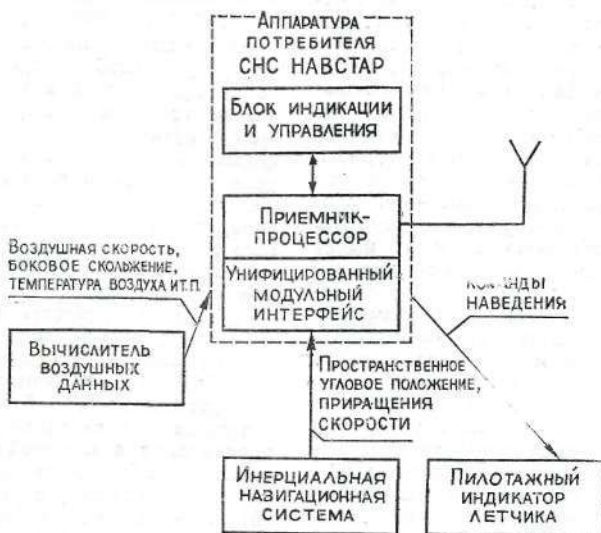
Рис. 3. Взаимодействие навигационной аппаратуры с системой управления бомбометанием
